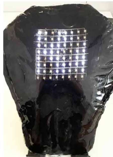
Funktionsmuster Rückenprotektor für Motorradfahrer mit integrierten LEDs zur Darstellung von Zeichen, Buchstaben, Symbolen und Laufschrift
