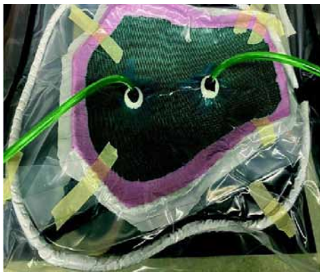
Vakuumprozess zur Herstellung des Funktionsmusters
