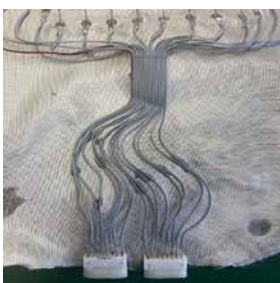
Abb. 3: Flachbandkabel mit Lötösen und Außenschnittstelle in Form von JST - Buchsen
